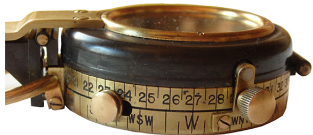
Seitliche Skala mit Arretiermechanismus der Perlmutscheibe
