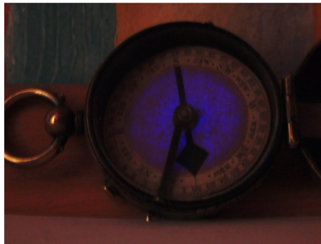
Skala nachleuchtend mit stark herausstechendem Marschrichtungspfeil
