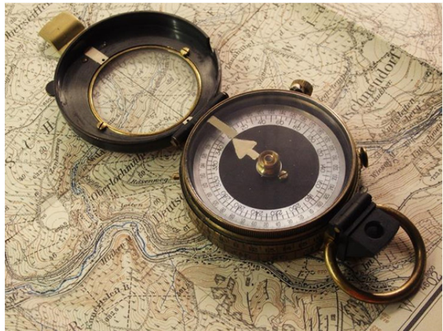
Verner`s Pattern auf Meßtischkarte „Olbernhau“ aus dem Jahre 1910 beim Einnorden der Karte
