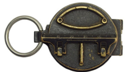
Gehäuseboden Armeemodell mit umklappbarer Anlegекante
