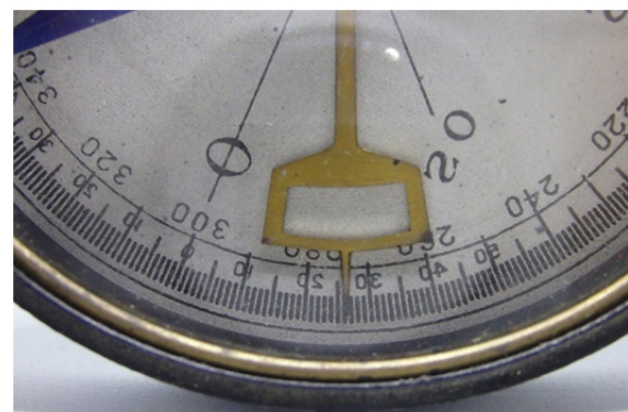
Neigungsmesser in die Skala integriert
