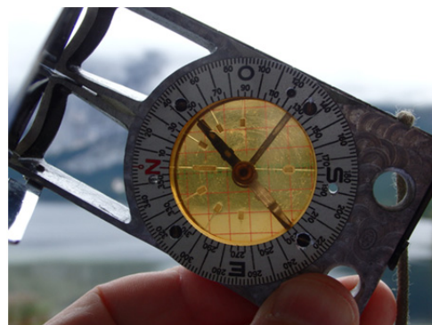
Winterer Bussole bei Messen von Höhenwinkeln
