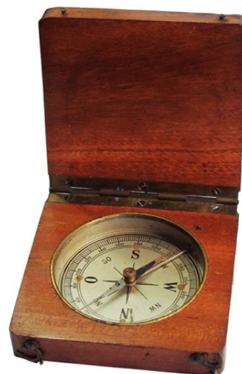
C. Stockert & Sohn Kompassmodell in Holzbox mit Deklinationskorrektur von 10 Grad West ca. 1915, Deutschland
