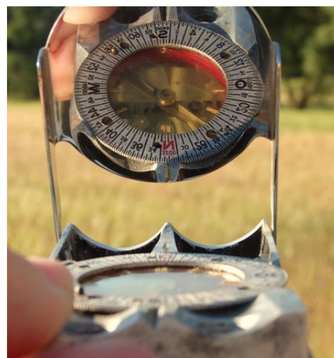
Ablesung an der Nadel über den Spiegel
