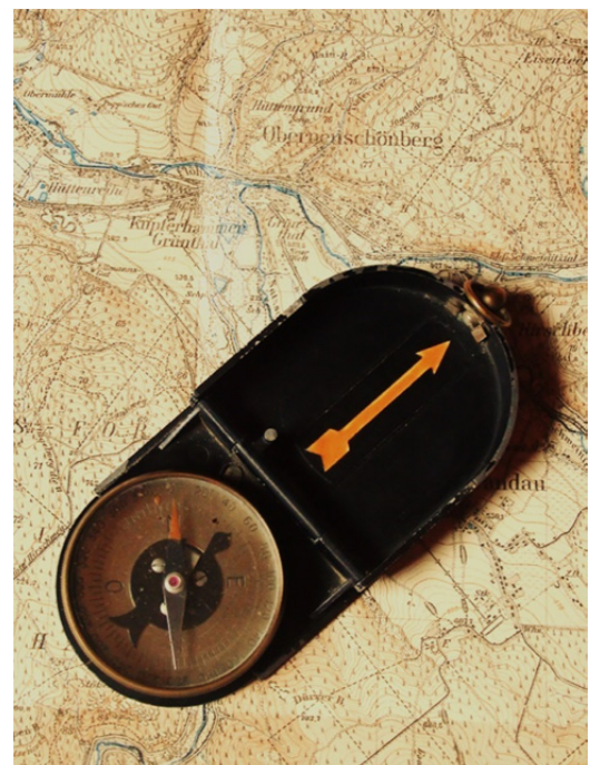
Ermitteln der Marschrichtung mittels dem Modéle 1922 auf einer Meßtischkarte 1:25.000
