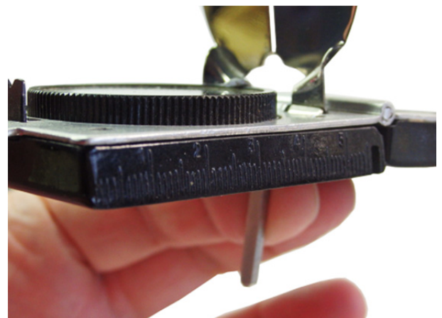
Haltemechanismus des Marschkompasses I Patent 1936 – D.R.P.
