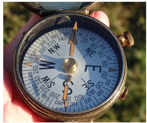
Skala mit radiumhaltigem Leuchtmittel
