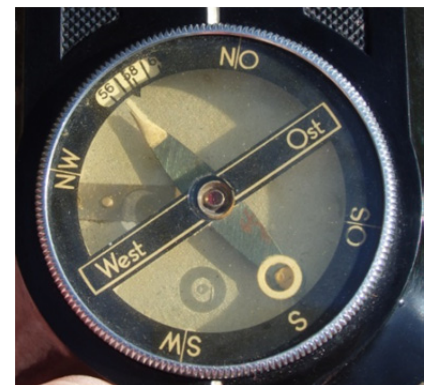
Skala mit Ablesung der Richtung
