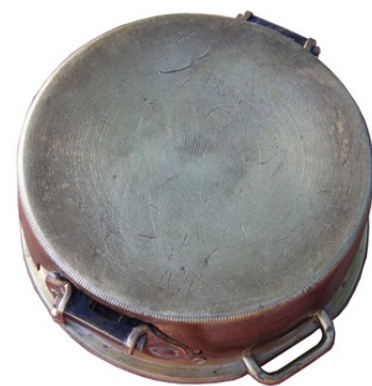
Messingdeckel schützt die Skala
