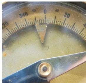
Deklinationskorrektur mit 5 Grad West
