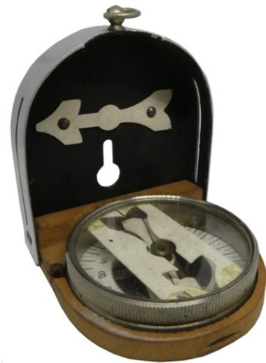
Diopterbussole aus dem Jahre 1905 nachleuchtend durch Balmainflüssigkeit
