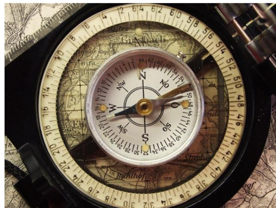
Skala 64-00 Strich rechts- und linksdrehend
