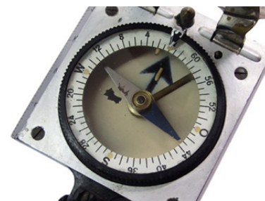
Skala 64-00 Strich linksdrehend mit nachtleuchtendem Marschrichtungspfeil
