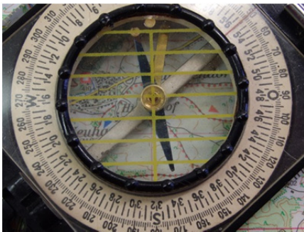
Kührt II mit Steinlagerung der Nadel
