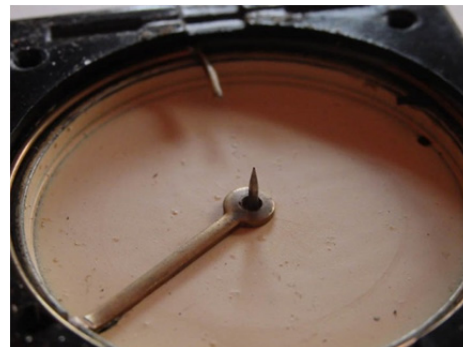
Gehäuseboden mit Pinne und verstellbarem Deklinationsstift
