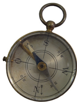
Metallskala ohne Gradeinteilung mit Arretierung K. S. Stockert
