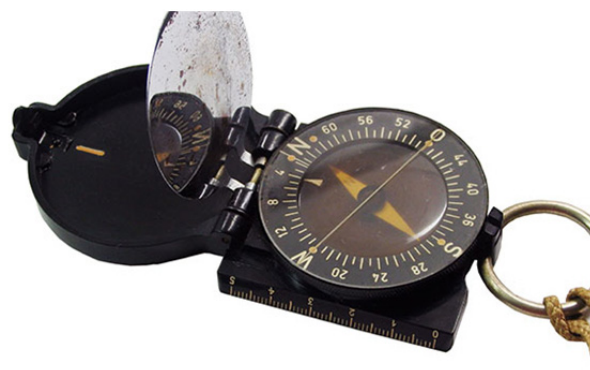
MK II geöffnet mit OST-WEST Markierung zum Anlegen an die Ortsnamen der Landkarte
