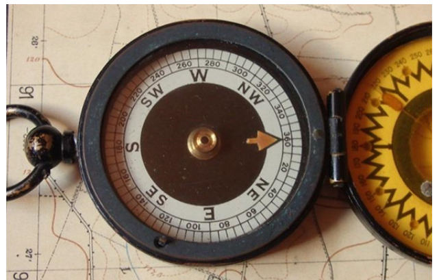
Skala 360 Grad rechtsdrehend
