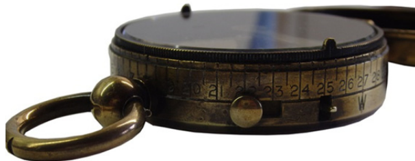
Seitenansicht mit Feststellhebel, Arretierstift und Randskala
