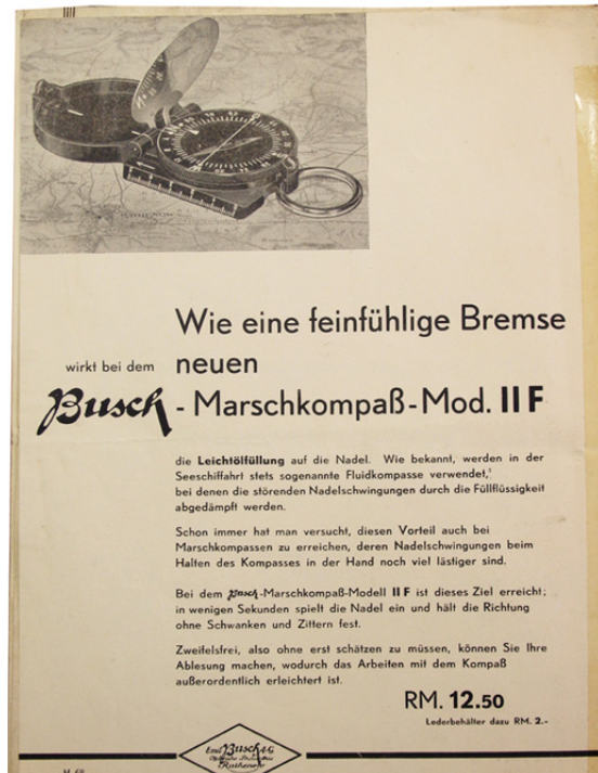
Informationen zur Fluidkapsel aus der Gebrauchsanleitung aus dem Jahre 1935
