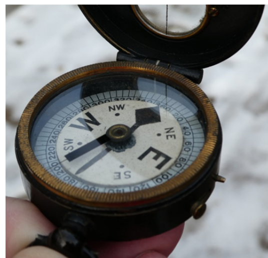
permanente und kurzfristige Arretierung ist seitlich angebracht
