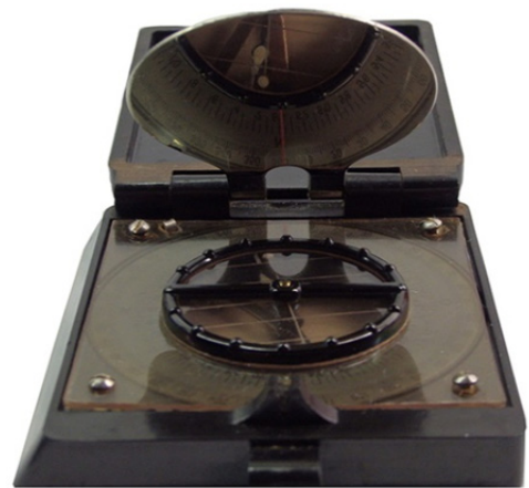
Anvisieren eines Zieles über Kimme und Korn, Ablesung mittels Spiegel
