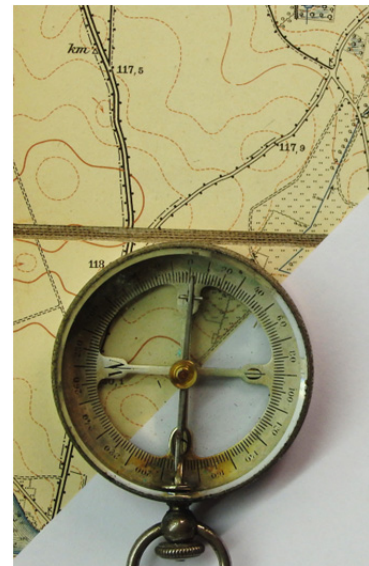
K. S. Stockert Kartenkompass mit Ermittlung der Marschrichtung zum Ziel
