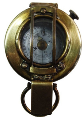
Ablesung bei geschlossenem Deckel
