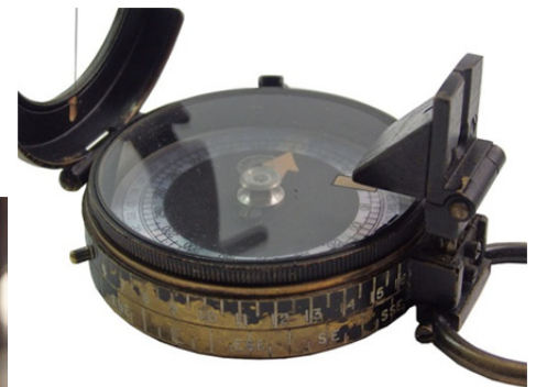
Prisma zur Ablesung der Skala
