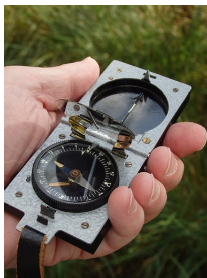
MK II aus den 1940er Jahren mit Ablesung an der Kompassnadel
