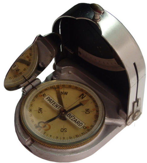
UBK – Patent-Bézard mit 32-00 Strich versetzter Skala
