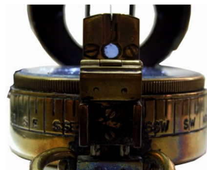
Anvisieren über Prisma und Visierstrich
