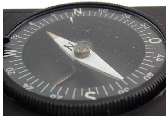
Skala mit Deklinationskorrektur
