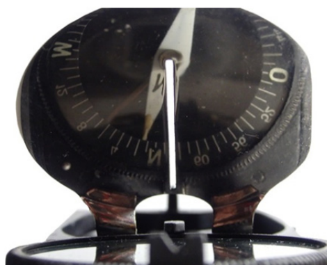
Anvisieren über den Peilschlitz
