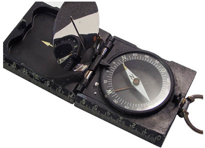
Marschkompass aus Elektron aus dem Jahre 1940
