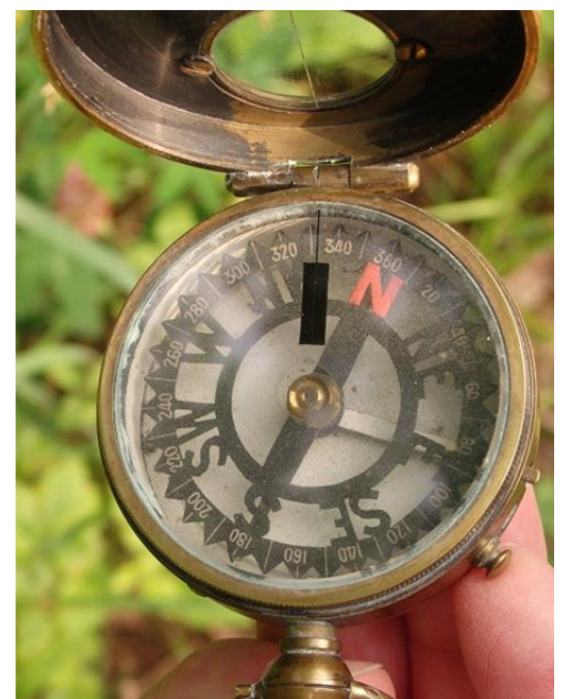
Skala 360 Grad rechtsdrehend „Skeleton Dial“
