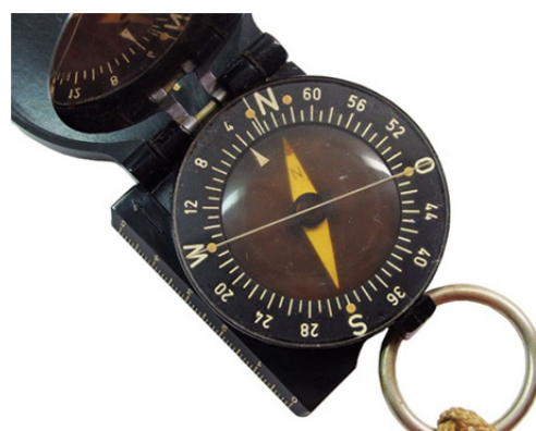
Skala 64-00 Strich linksdrehend Deklinationkorrektur bei 180 Strich WEST
