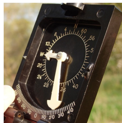
Kippen des Deckels und Ablesen des Steigung
