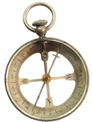
K. S. Stockert ca. 1915 Remontoirarretierung und Balkennadel
