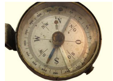
Deklinationskorrektur bei 9 Grad West
