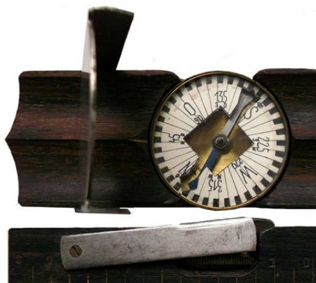
Urmmodell der Winterer Busssole, Ablesung ähnlich dem Bézard-Kompass „Großes Armee Modell 1910“ Quelle: Compasspedia
