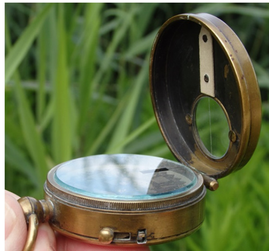
Ansicht seitlich mit Balmain Richtungspfeil und Arretier- und Sperrhebel
