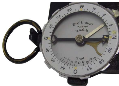
Kompass-Skala 64-00 Strich linksdrehend
