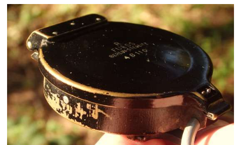
Gehäuse mit eingeklappter Anlegekante
