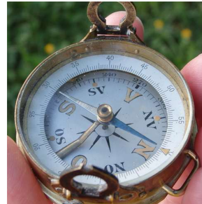
Skala mit Visiereinrichtung
