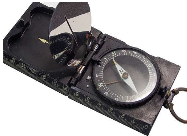
Marschkompass aus Elektron aus dem Jahre 1940
