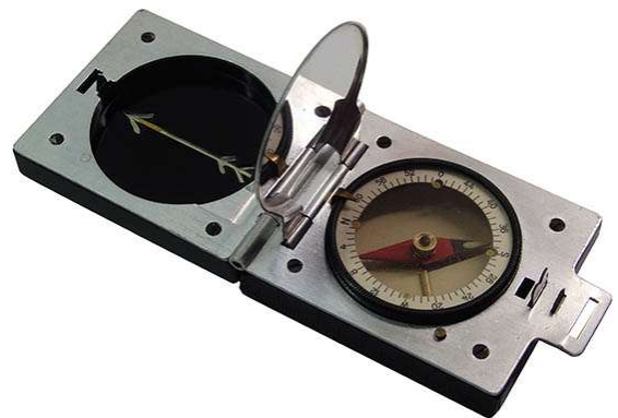
Marschkompass Modell I für den Geländesport
