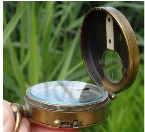
Ansicht seitlich mit Balmain Richtungspfeil und Arretier- und Sperrhebel
