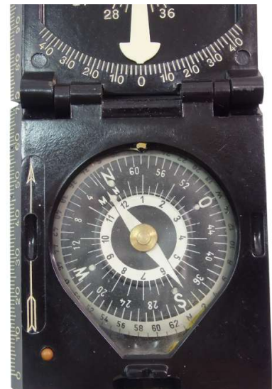
Kompassskala 64-00 Strich linksdrehend
