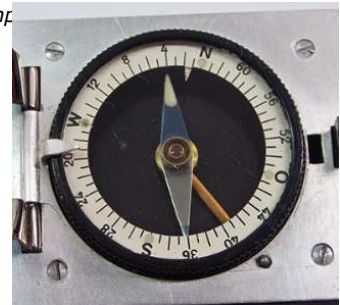
Skala des Touristenkompasses mit Stabilisationsring
