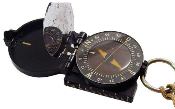
MK II geöffnet mit OST-WEST Markierung zum Anlegen an die Ortsnamen der Landkarte
