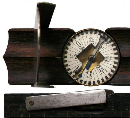
Urmodell der Winterer Busssole, Ablesung ähnlich dem Bézard-Kompass „Großes Armee Modell 1910“
