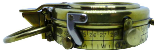
Arretierhebel des Kompassrose
