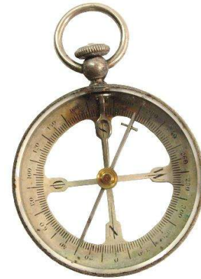
K. S. Stockert ca. 1915 Remontoirarretierung und Balkennadel
