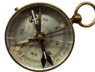
Taschenkompass von K. S. Stockert mit Balmainpapier
