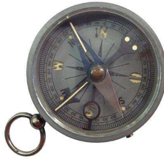
Taschenkompass mit Marschrichtungspfeil
