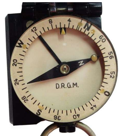
Skala 64-00 Strich linksdrehend mit D.R.G.M.
