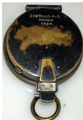
brüniertes Gehäuse mit gerändeltem Rand
