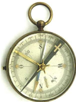
Metallskala mit Balmainpapier und Direktionslinie Quelle compassipedia
