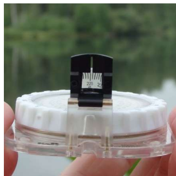
Peilung mit Marschrichtung und Gegenrichtung für die Kreuzpeilung
