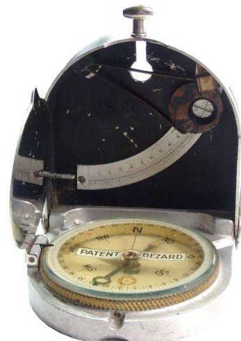
Modell II mit Pendeleinrichtung ohne Libelle aus den 1920er Jahren
