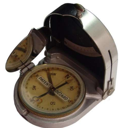
Orientierungsbussole mit Neigungsmesser und um 32-00 Strich versetzter Skala
