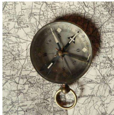
Bussole beim Einnorden mit Berücksichtigung der Deklination
