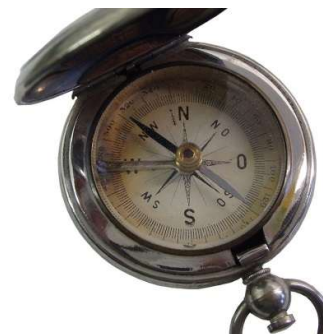
Taschenkompass in Uhrengehäuse auf Achathütchen
