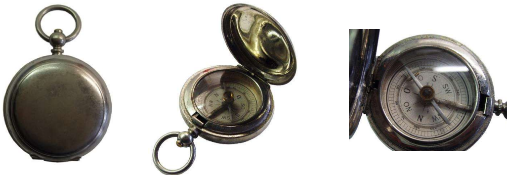
Taschenkompass Modell 790 aus dem Jahre 1910 im Gehäuse einer Taschenuhr mit Sprungdeckel
