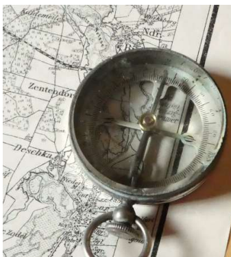
Kartenkompass beim Einnorden ohne Berücksichtigung der Deklination
