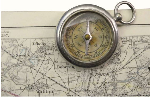
Karte des Deutschen Reiches 1:100.000 aus dem Jahre 1890 mit einem zeitgenössischem Taschenkompass von C. Stockert & Sohn beim Einnorden der Karte
