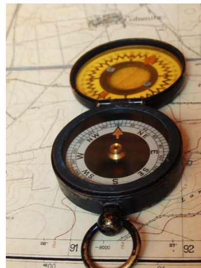
Übertragen der Marschrichtung in die Karte
