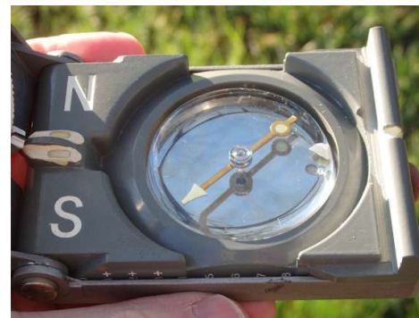
Kompasskapsel mit Magnetnadel
