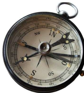
Geländekompass mit Marschrichtungspfeil
