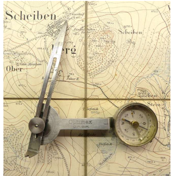
Ermitteln von Richtungen und Entfernungen aus der Landkarte mittels Wegzeigernadel
