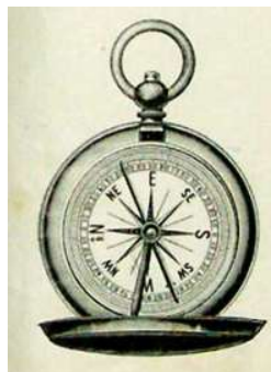
Taschenkompass in Uhrengehäuse auf Achathütchen
