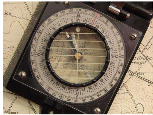
Nutzen der W-O-Linien ohne Parallaxenfehler
