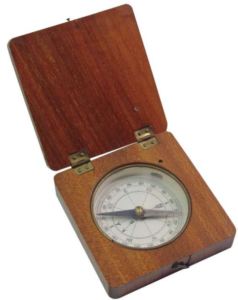
Zulegeinstrument für Meßtisch der Manufaktur Morin aus Paris gegen Ende des 19. Jh.
