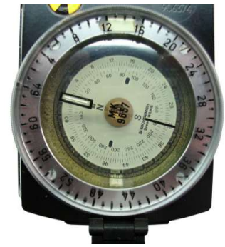
Kompassrose mit transparentem Rand zum Ablesen der Werte
