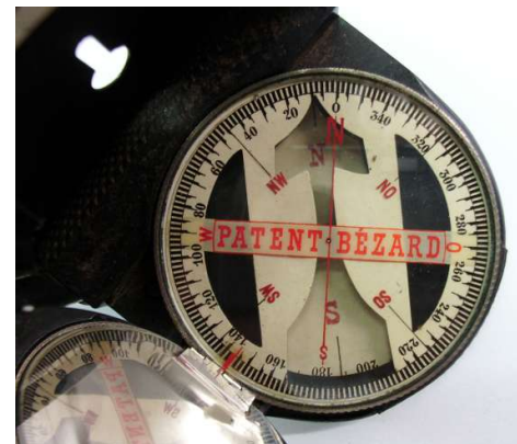
Magnetpfeil und Pfeilausschnitt werden deckungsgleich gebracht
