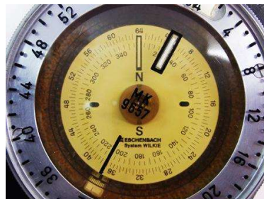
Schwimmende Kompassrose mit Deckelglas
