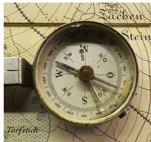
Kompasskapsel rechtsdrehend 360 Gradteilung
