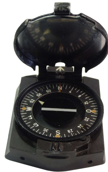
rechtsdrehende Kompassskala 64-00 Strich
