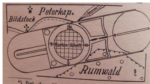
Übertragen der Marschrichtung in die Karte, hier mit dem Modell 1
