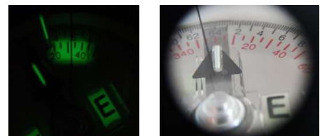
Ableseung bei Nacht und bei Tag durch Tritiummarkierungen
