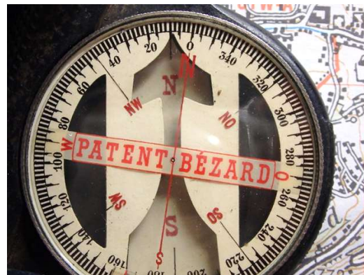
Armeemodell II Patent Bézard Einteilung in 360 Grad linksdrehend
