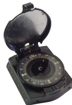
MK der Emil Busch AG mit Wirbelstromdämpfung
