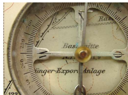
Anlegen entlang eines Schriftzuges in der Karte
