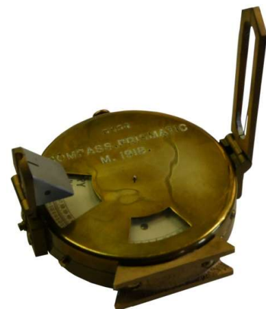
mit Prisma und aufgeklappem Visier
