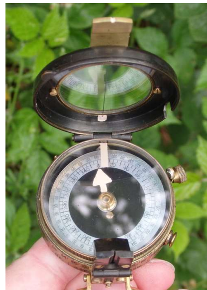
Ablesung der Marschrichtung ohne Prisma
