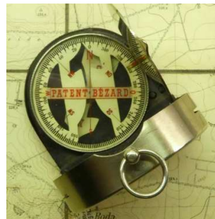
Nordpfeil kann vernachlässigt werden, nur Skala wird nach Karten-Nord orientiert
