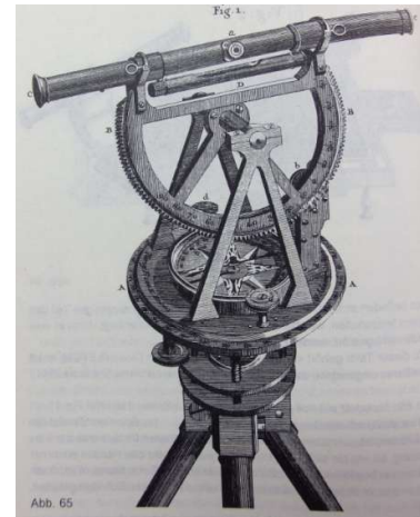
Theodolit mit teleskopischen Dioptern
