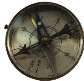
Geländekompass ohne Gradeinteilung mit Marschrichtungspfeil
