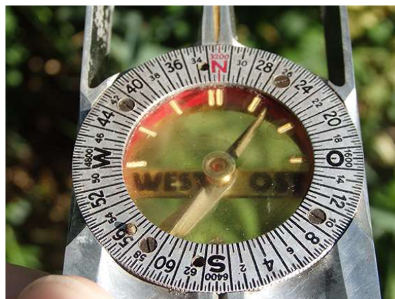
Skalenbeobachtung von oben freihändiges Verwenden man erkennt das WEST-OST-Lineal
