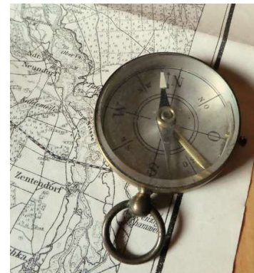
Bussole beim Einnorden der Karte am Kartenrand mit Berücksichtigung der Deklination
