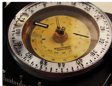
Schwimmende Kompassrose mit Deckelglas
