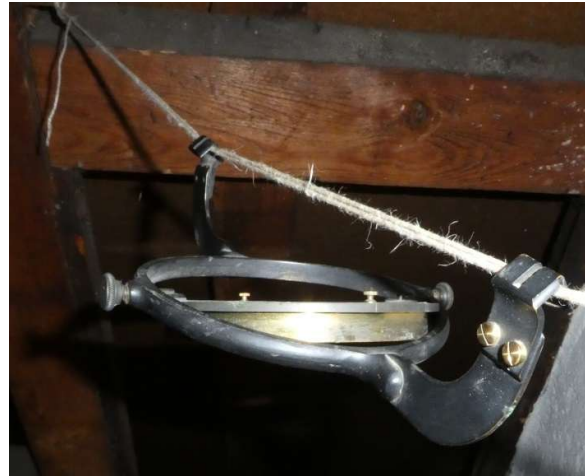
Hängekompass mit seiner kardanischer Aufhängung
