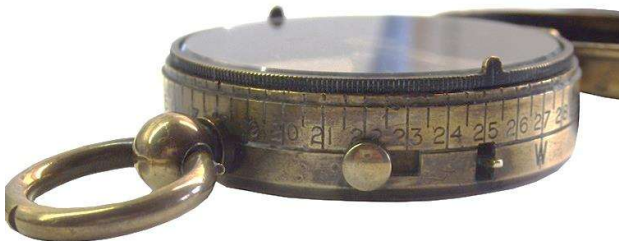
Kimme und Korn auf dem Gehäusedeckel
