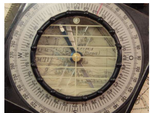
Paralleldrehen der Skala nach Ortsnamen
