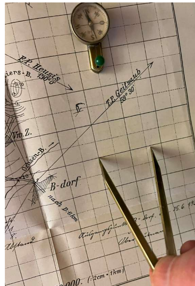
Entfernung aus Kroki entnehmen
