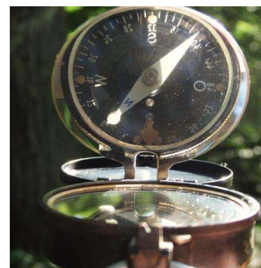
Nordteil der Nadel steht im Beispiel nicht auf der Deklinationsmarke
