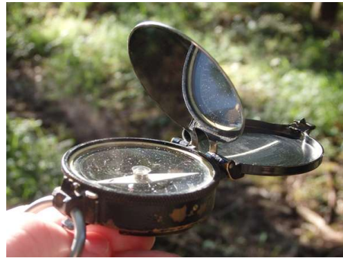
Haltung des MK I beim Anpeilen eines Zieles
