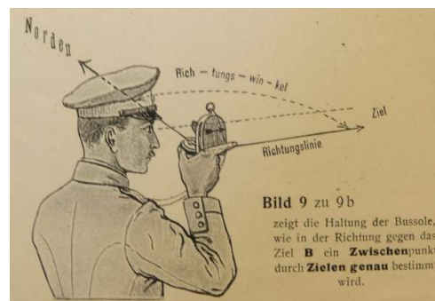
Die Haltung der Bussole aus derr Gebrauchsanleitung 1910
