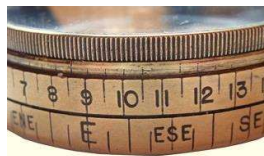
seitliche Beschriftung in Gradteilung und Himmelsrichtungen
