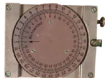
Subtraktionsscheibe auf der Unterseite des Gehäuses
