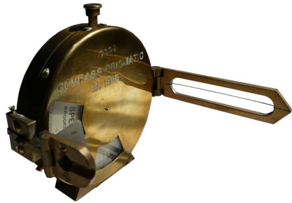
Zum Ermitteln der Steigung bzw. Gefälle, Ablesung über das Prisma
