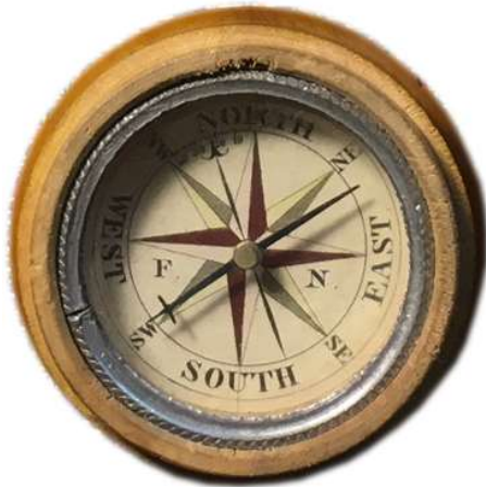
Kompassrose Negelein , für den Export mit einer Deklinationskorrektur von 23 Grad West
