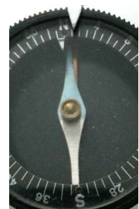
neue Nadelform rechtsdrehende Skala beim Folgemodell
