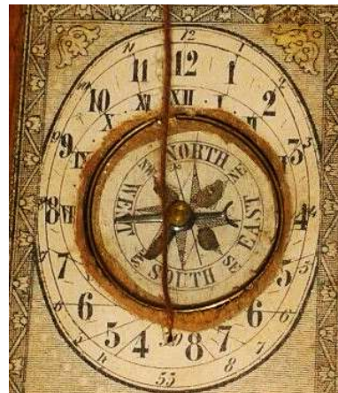
die Kompasskapsel mit einer typischen Kompassnadel für das 19. Jahrhundert
