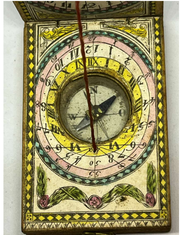
Deklinationsskorrektur und Magnetnadel aus dem späten 18. Jahrhundert
