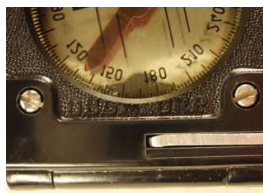
Gehäuseboden mit Haltehebel und sichtbarer Skala
