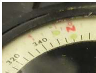
kombinierte Skala Grad und Strich
