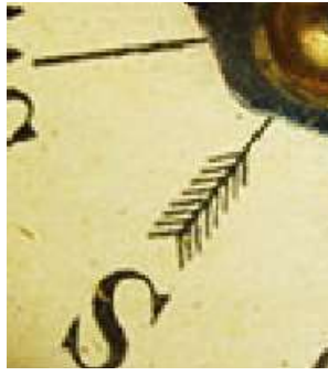
Kompassnadel ähnelt Stockert aus dem 19. Jhd., der Stockert Deklinationspfeil ist identisch
