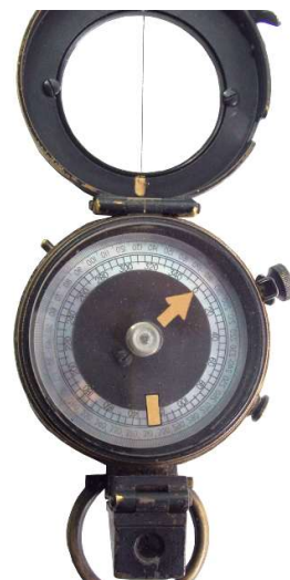
Gehäuse geöffnet Skala 360 Grad rechtsdrehend
