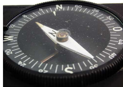
Kompassnadel mit Stabilisierungsring aus Kupfer
