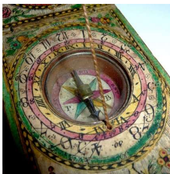
Der Kompass mit Faden für den Schattenwurf und den Initialen PB in der Skala
