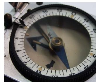
Kupferring unterhalb der Kompassnadel ab dem Jahr 1937
