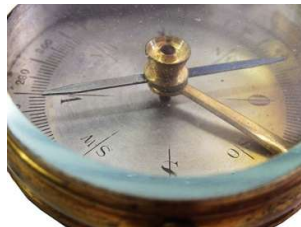
Taschenkompass Seitenansicht der Nadellagerung
