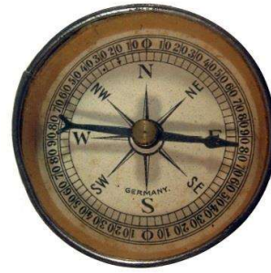
Mod. 860 , wahrscheinlich 19. Jahrhundert ; Pfeil in Skala als Deklinationskorrektur; Kompassrose in der Skala
