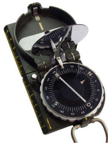
Askania Handkompass der 1950er Jahre mit Wirbelstromdämpfung
