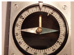
rautenförmige Magnetnadel ohne Achatstein
