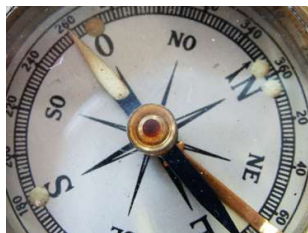
Versilberte Metallskala Windrose und Deklinationspfeil
