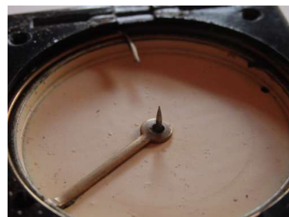
Deklinationskorrektur als Innenring zum Verstellen
