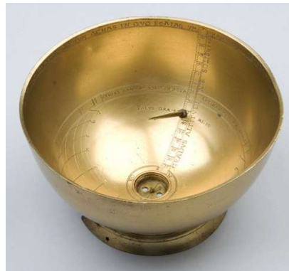
Bechersonnenuhr des Georg Hartmann mit Kompass auf dem Becherboden
