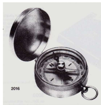
Messinggehäuse, Silberskala 360°, international, Achatlagerung, Leuchtpunkte, Deckel, drehbar, FLUIDDOSE 45mm, auch vernickelt möglich
