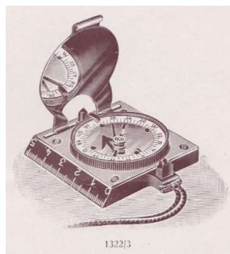
Nachtleuchtender Marschkompass , Bakelit, Aluminium, Radiumpunkte, 64-00 Strich mit Radiumpunkte, Messmarke für Teilstrich-Feststellung Marschrichtungspfeil auf Bodenfläche
