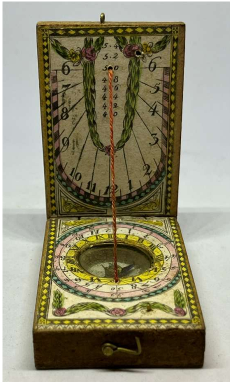
Polhöhenverzeichnis bei 50 Grad eingestellt
