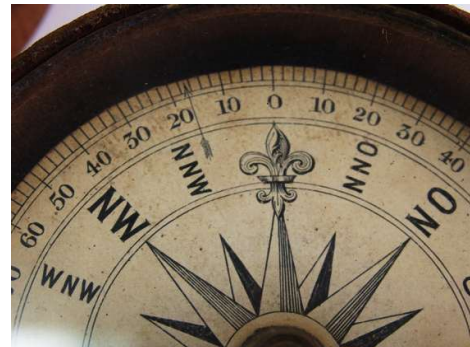
Deklinationspfeil bei 17 Grad WEST
