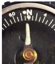
Deklinationskorrektur bei 100 Strich WEST
