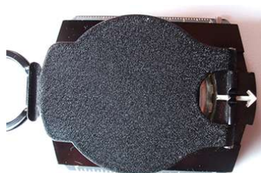
der Deckel als Spiegel und Schutz links die Spiegellarretierung und der Daumenring
