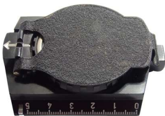
Das Bakelitgehäuse mit Deckel mit dem Haltehebel
