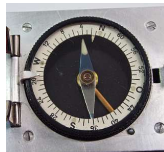
Skala des Touristenkompasses mit Stabilisationsring
