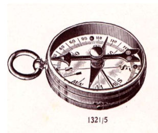
Messinggehäuse; Ia; versilberte Metallskala; Achat drehbarer Marschrichtungspfeil, Radium; Grad oder 64-00 Strich
