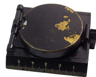
Der Deckel besteht aus Messing, das Gehäuse aus Bakelit
