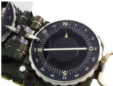
Skala mit 64-00 Strich Einteilung und verstellbarer Missweisungskorrektur
