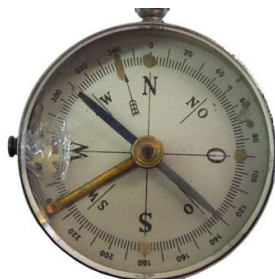
Skala mit Deklinationspfeil und den drei Endfäden und Marschrichtungspfeil
