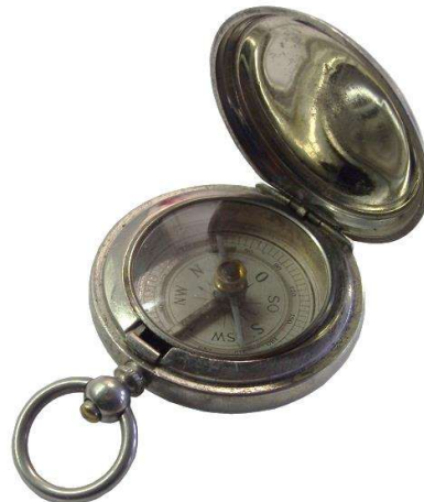
TK Modell 790 mit Metallskala und Balkennadel
