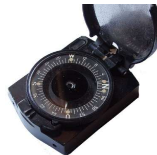
Wirbelstromdämpfung der Emil Busch AG
