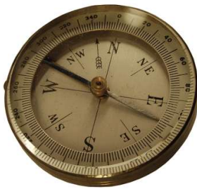
alt wirkende Skala mit Deklinationspfeil der 1930er Jahre
