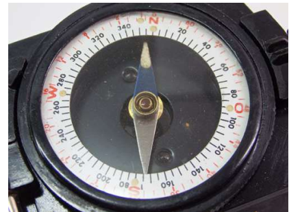
Kombinierte Skala in Grad und Strich
