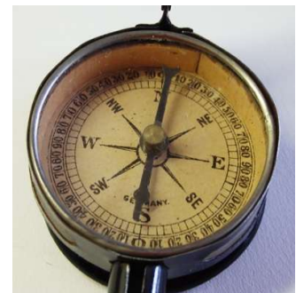
Skala in Quadranten und eine einfache Magnetnadel
