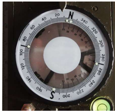
Stockert Marschkompass II – Skala mit Inklinometer und Balkennadel
