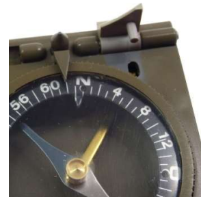
Nadelarretierung durch umklappbaren Hebel
