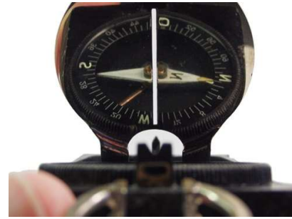
Visierung über Kimme und Korn und den Visierschlitz
