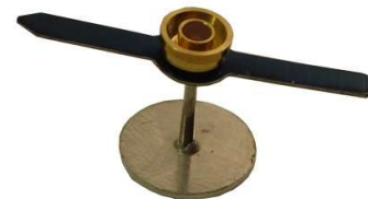
Magnetnadel mit Steinlager auf einer Pinne
