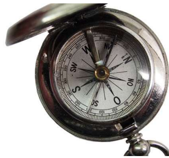
Taschenkompass im Uhrengehäuse mit Sprungdeckel
