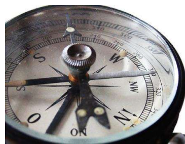
Marschrichtungspfeil Singer Modell Nr. 26/ 50mm
