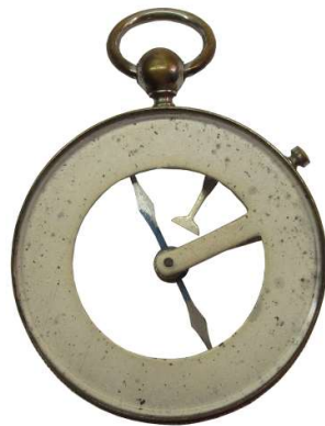
Singer Kartenkompass ca. 1915 bis 1930 Messing Aufhängung der Nadel
