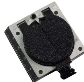
der Deckel mit Sehschlitz
