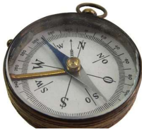
Skala mit Deklinationspfeil und Endfäden
