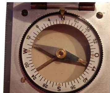
Marschkompass I - Skala linksdrehend mit Deklinationskorrektur
