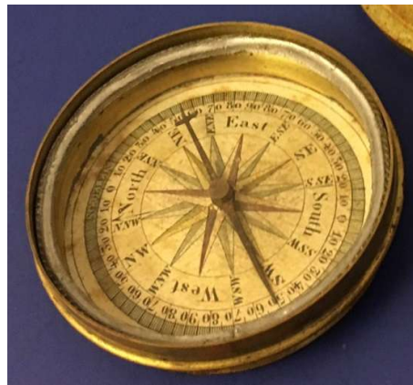
Kompasswindrose im Messinggehäuse mit Deckel Negelein ca. 1845
