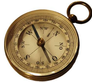
alte Skala, Deklinationspfeil Ähre vermutlich 1910 bis 1930
