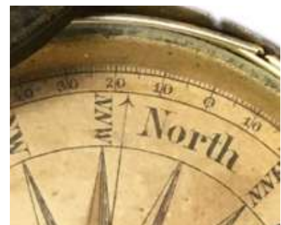
Deklinationskorrektur bei 16 Grad WEST
