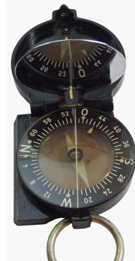
MK II F mit Visierspalt im Spiegel
