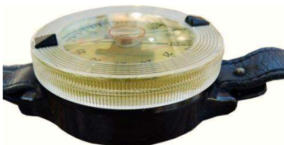
Kompasskapsel mit geriffelter Seite
