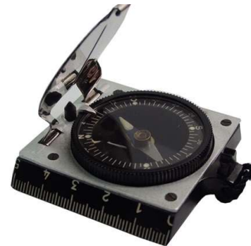
Ring unterhalb der Kompassnadel
