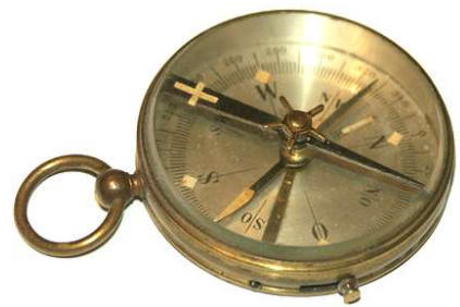
Taschenkompass mit Metallskala und Marschrichtungspfeil wie im Katalog von 1910 von K. S. Stockert
