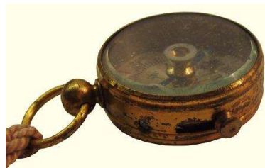
Facettglas mit Arretierungsmechanismus der Magnetnadel
