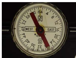
Marschkompass 5004 mit Deklinationskorrektur
