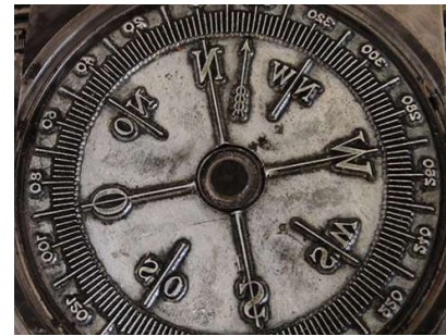
Prägestempel für eine Skala
