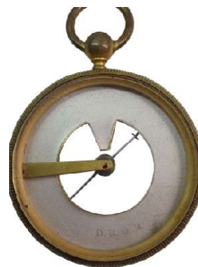
Singer Kartenkompass ca. 1900 Messing Aufhängung der Nadel D.R.G.M.
