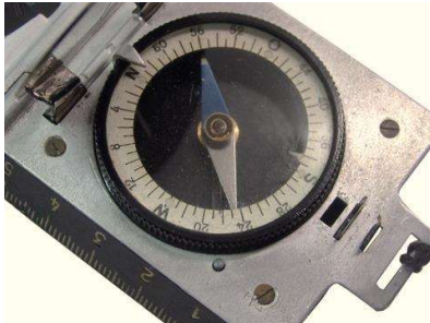
Skala 64-00 Strich linksdrehend mit Raute als Magnetrnadel
